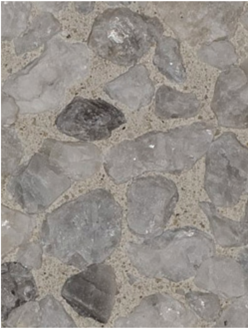
Instøbte sten i beton, eks. sten fra Mols Bjerge
