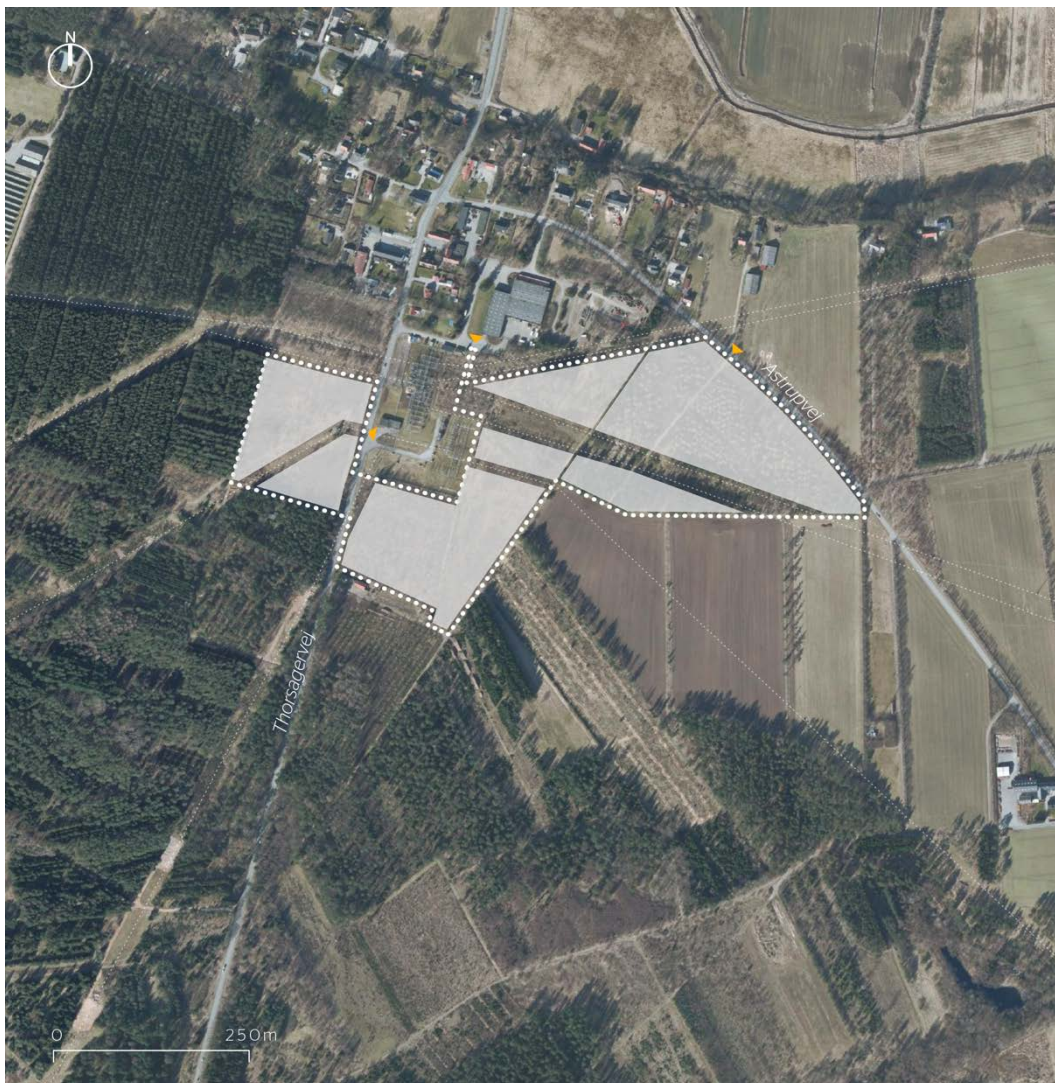
Figur 1: Afgrænsning af plan- og projektområdet der er vist med hvide prikker. Indenfor projektafgrænsningen ses, med lys grå flade, byggefelter for placering af solenergianlægget, samt adgangsveje med orange markeringer.
